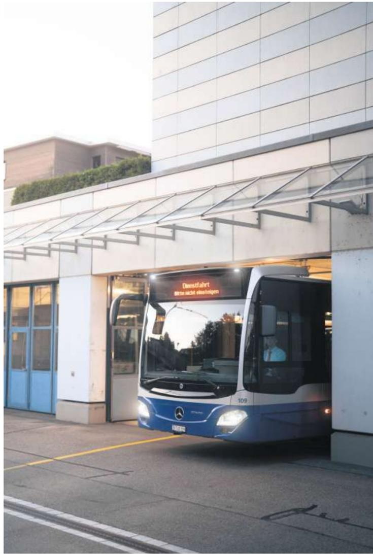
Ein Dieselsebus verlässt das VZO-Depot in Grüningen: Für einen Elektrobus mit Akku auf dem Dach ist die Zufahrt zu niedrig.
